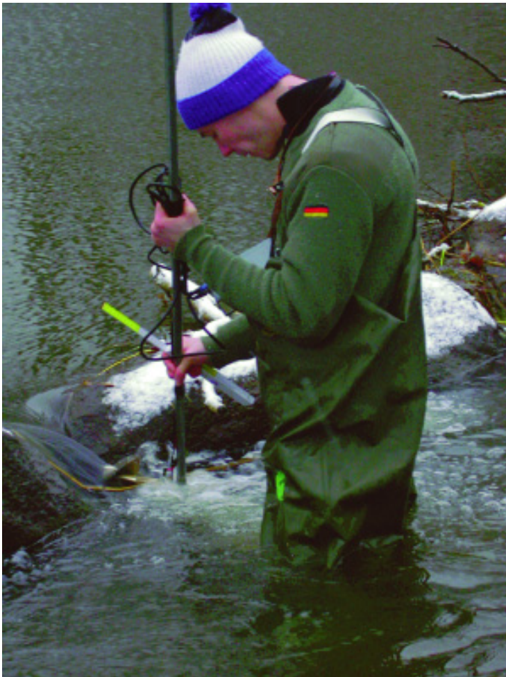
Bild 9: Messung der Strömungsgeschwindigkeiten nach Bau der Sohlgleite durch C. Lausen.
